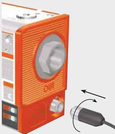
Un unique connecteur M12x1 à 5 broches, avec un degré de protection IP67, permet de connecter à la fois le pressostat et le démarreur progressif ou la vanne de sectionnement. Ce système réduit le temps de câblage et améliore la fiabilité des raccordements. Une fois raccordé sur ONE le degré de protection de l'ensemble devient IP65.
