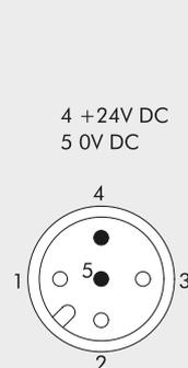
SCHEMA ELECTRIQUE DU PRESSOSTAT
